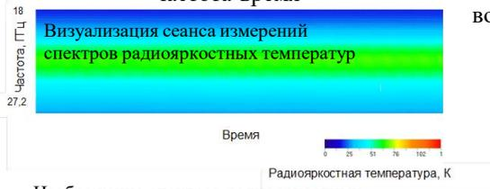
Визуализация сеанса измерений спектров радиояростных температур
